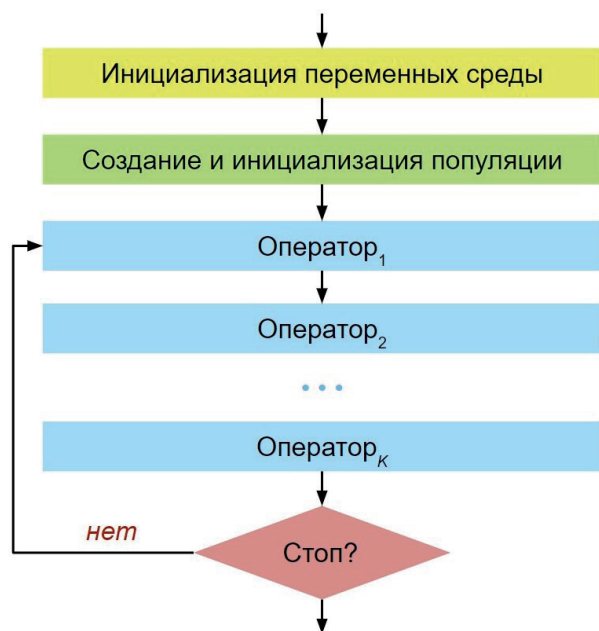
Р и с. 2. Структура популяционного алгоритма Fig. 2. Structure of the population algorithm
