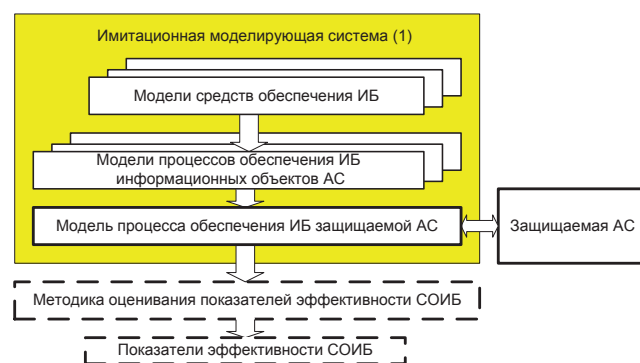
Р и с 1. Структурная схема имитационной моделирующей системы
