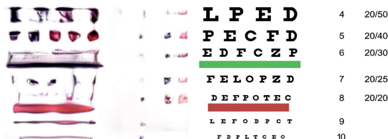
Р и с. 12. Сравнение качества восстановления VAE и DC-AE при коэффициенте пространственного сжатия = 12 [26]
