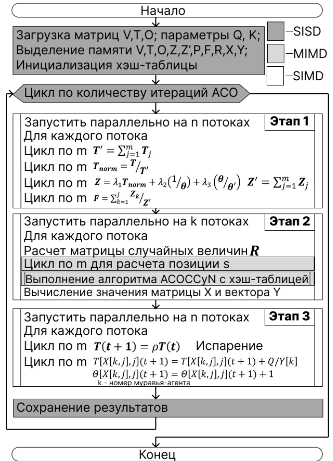
Р и с. 1. Алгоритм матричного метода АСО с разделением на SISD, MIMD и SIMD фрагменты
