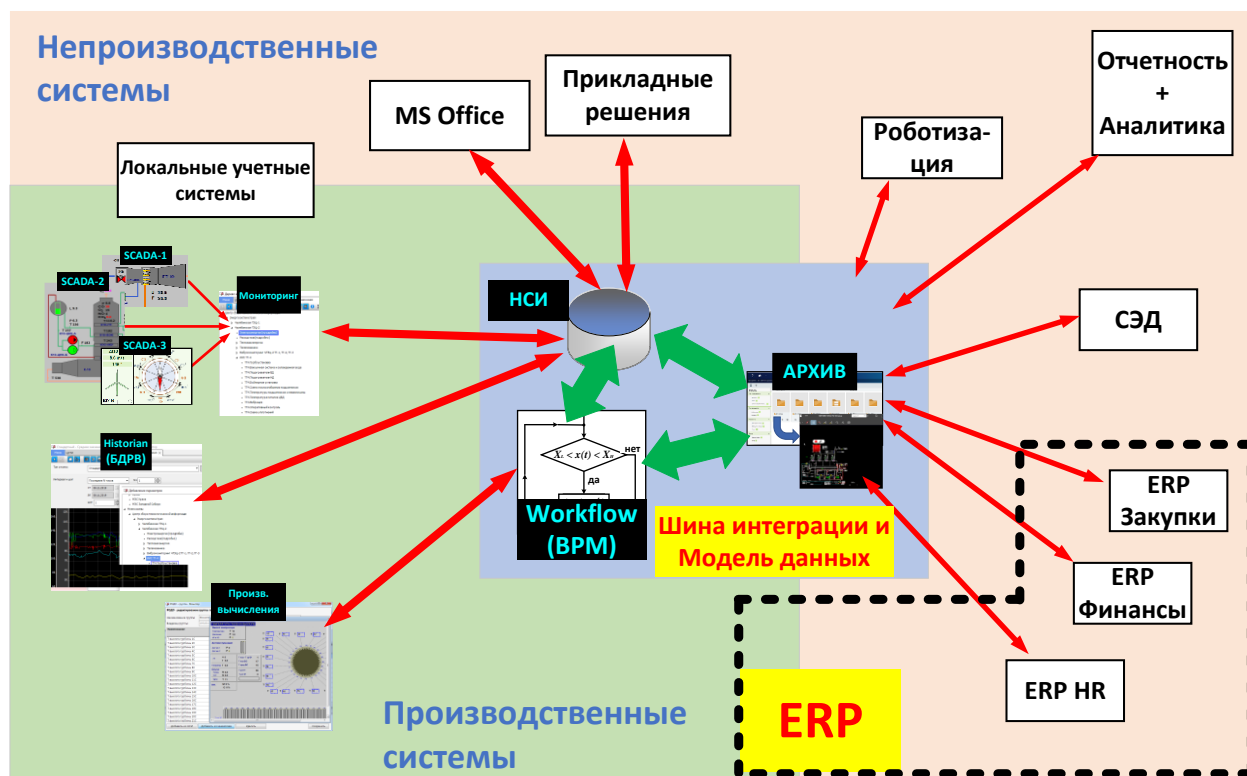
Р и с. 6. Построение модульного ИТ-ландшафта с переносом функционала ERP-системы на периферию Fig. 6. Building a modular IT landscape with transfer of ERP system functionality to the periphery
