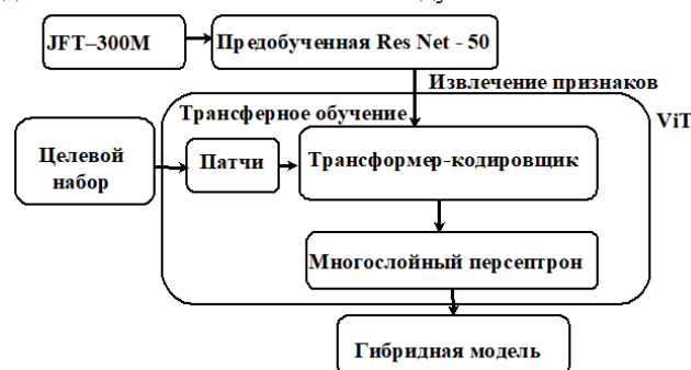
Р и с. 3. Создание гибридной модели CNN + ViT F i g. 3. Creation of a hybrid CNN + ViT model
