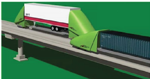
Рис. 3. Концептуальный шаттл для доставки контейнеров и автомобильных прицепов по цифровой железной дороге [43]
