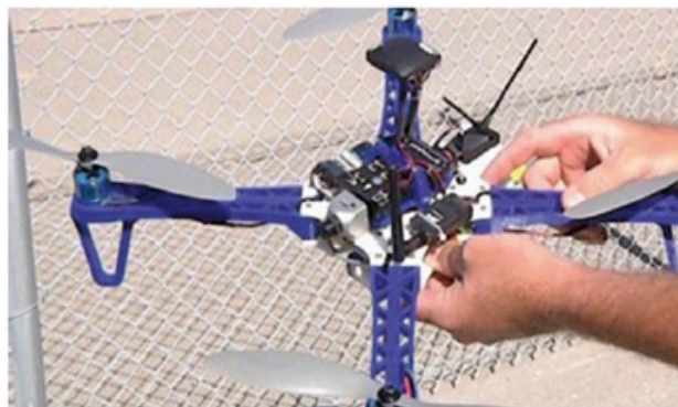
Рис. 6. Дрон, напечатанный на 3D принтере (BMC США) [39]
