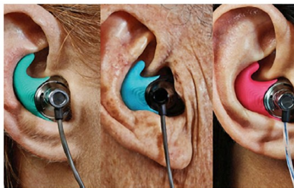
Рис. 18. Индивидуальные слуховые аппараты, изготовленные на 3D принтере [39]
