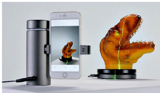
Рис. 17. Новые дешевые устройства лазерного 3D сканирования, совмещенные со смартфоном [39]
