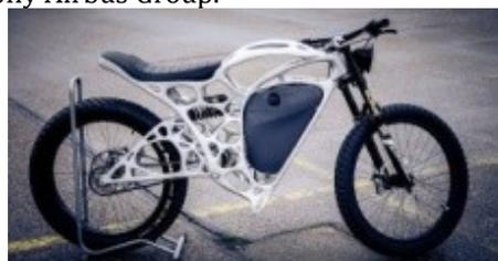
Рис. 4 Мотоцикл, напечатанный на 3D-принтере
