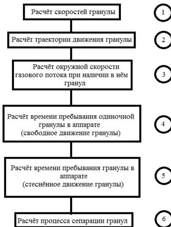
Рис. 1. Блок-схема алгоритма расчёта гидродинамических характеристик вихревого гранулятора
