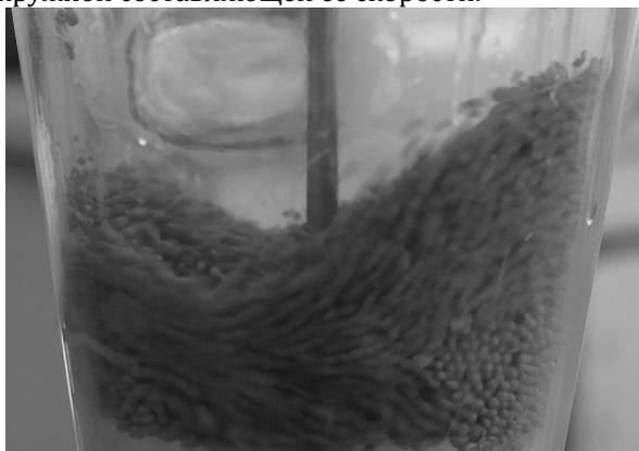
Рис 6. Траектория движения гранул в рабочем пространстве вихревого гранулятора
