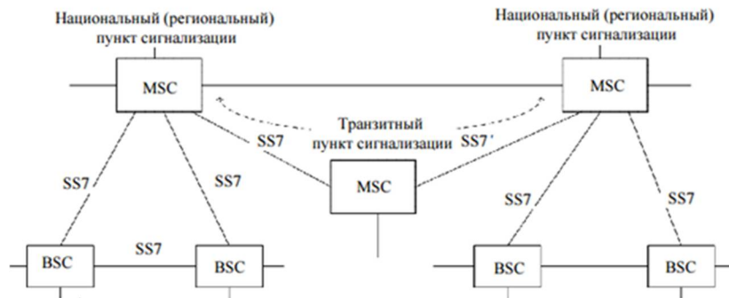
Рис. 9. Упрощенная схема сети SS7 в системе GSM-R
