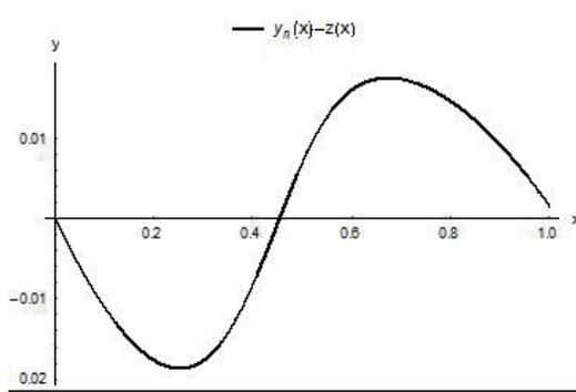
Рис. 5 График разности  $y_n(x)$  при  $n = 3$  и приближённого решения, построенного в пакете Wolfram Mathematica для  $A = 10$ .
