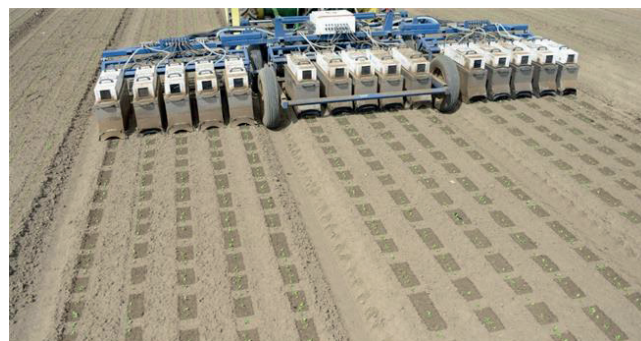
Рис. 22. Дизельная / электрическая система новых CAV тракторов позволяет точно управлять четырьмя шинами привода новой сеялки-прицепа с рассадой [18].
