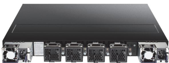
Рис. 7. Вид задней панели: модульные источники питания и вентиляторы Fig. 7. Rear panel view: modular power supplies and fans
