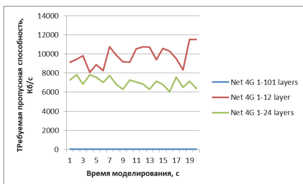
Рис. 7. Необходимая пропускная способность канала связи для максимально доступной производительности распознавания
