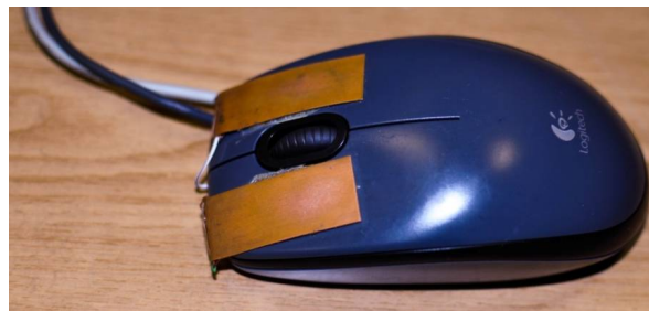
Fig. 4. Modified manipulator «mouse» layout to record GSR
