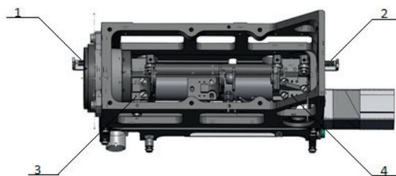
Р и с. 2. 3D-модель механизма панкратического объектива, выполненная в SOLIDWORKS
