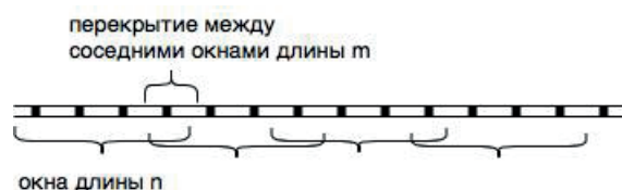
Р и с. 2. Пример разбиения временного ряда на окна Fig. 2. An example of splitting a time series into windows
