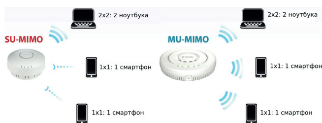
Р и с. 4. Сравнение конфигураций SU-MIMO и DL-MU-MIMO F i g. 4. Comparison of SU-MIMO and DL-MU-MIMO configurations
