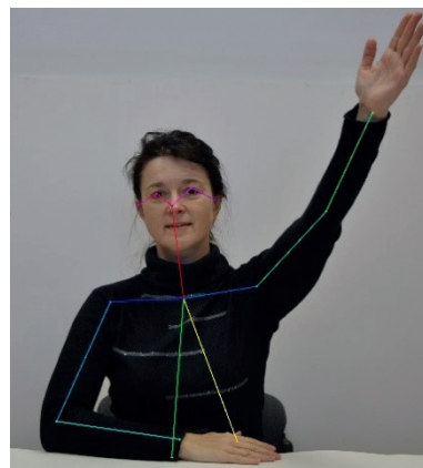
Р и с. 3. Аппроксимация позы «Поднятая рука» F i g. 3. Raised Hand Pose Approximation
