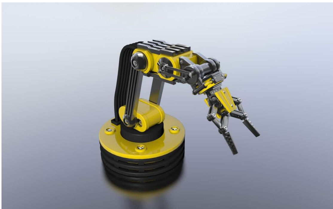
Рисунок 3. Манипулятор с устройством захвата, основанном на двух подвижных плоскостях.
