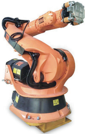
Р и с. 1. Манипулятор с устройством захвата, основанном на использовании магнетизма
