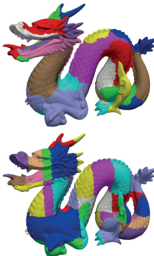
Р и с. 2. Визуализация декомпозиции тестовой расчетной сетки dragon на 32 домена с помощью алгоритма Фархата (сверху) и иерархического алгоритма (снизу)
