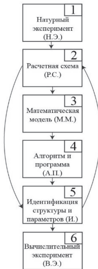
Р и с. 1. Общая схема процесса математического моделирования F i g. 1. General scheme of the process of mathematical modeling
