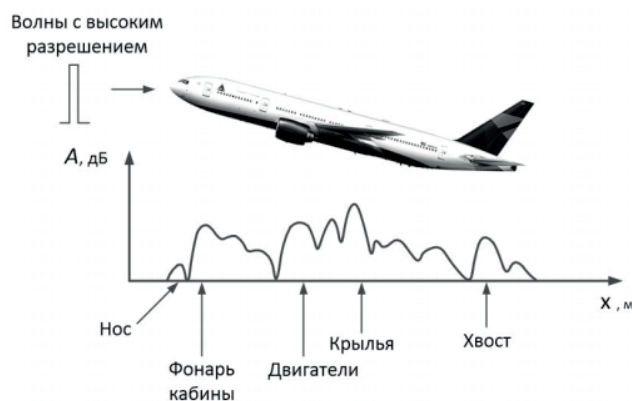
Р и с. 1. Формирование радиолокационного дальностного портрета F i g. 1. Formation of a radar range portrait
