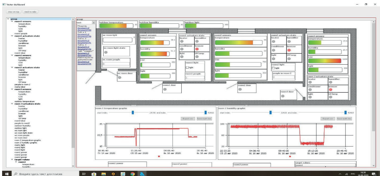
Р и с. 3. Вид виртуальной приборной панели, управляющей микроклиматом помещения, привязанной к плану помещения
