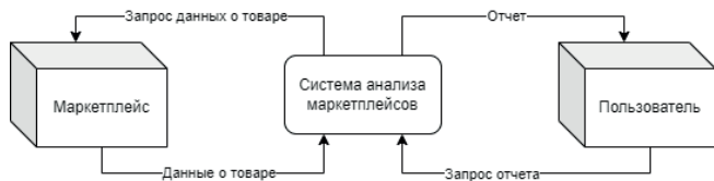
Р и с. 4. Диаграмма потоков данных нулевого уровня вложенности F i g. 4. Zero nesting level data flow diagram
