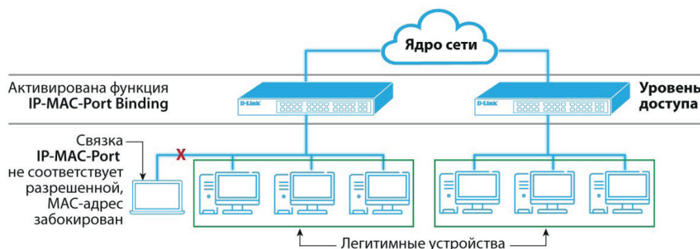
Р и с. 2. Принцип работы функции IP-MAC-Port Binding
